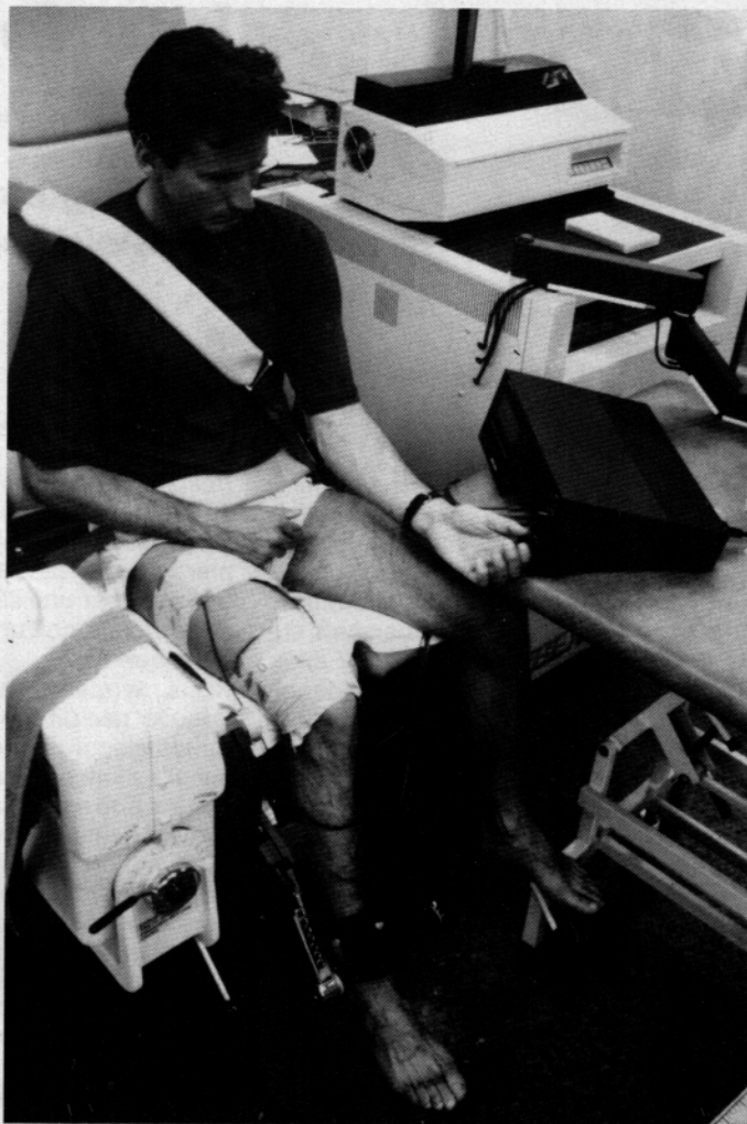
Abbildung 1: Positionierung des Probanden auf dem Cybex TM
